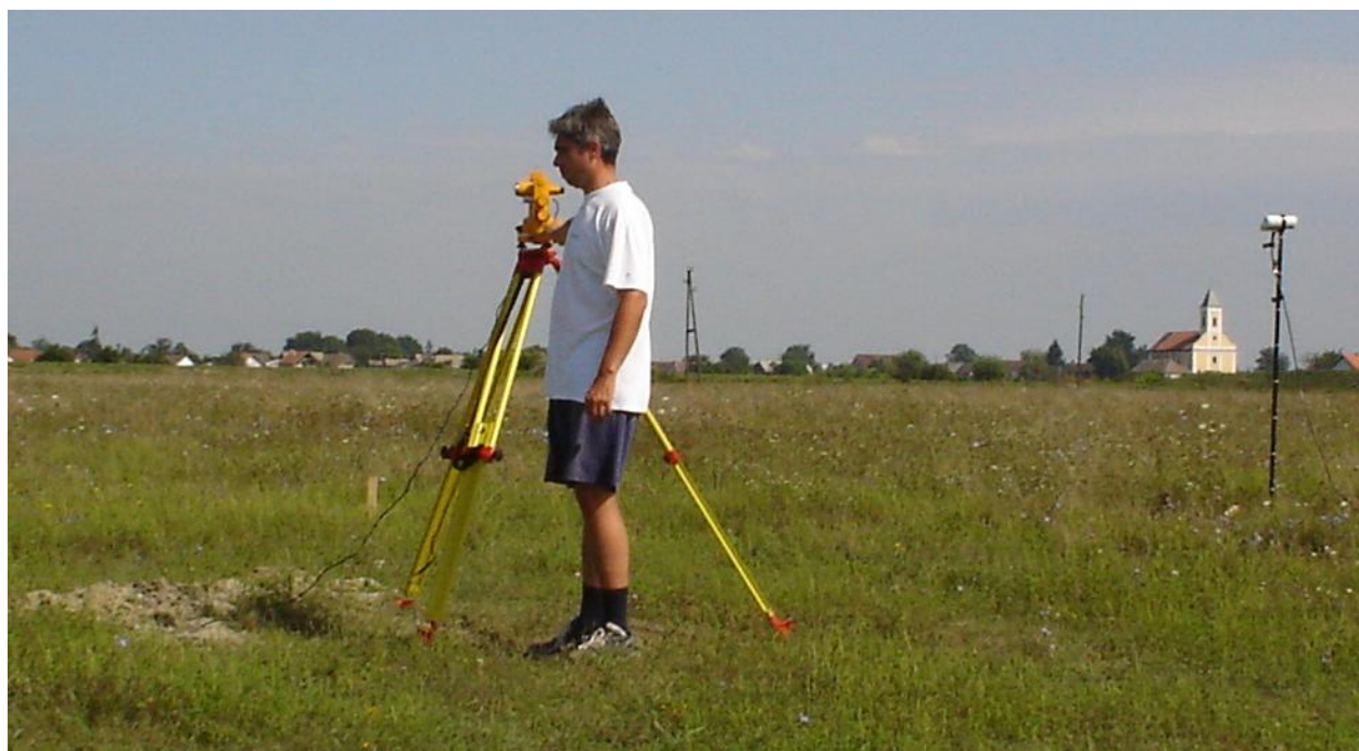
Slika. Izmjera deklinacije (DIM) na sekularnoj (SV) i totalnog intenziteta (PPM) na pomoćnoj točki (POM). Uz GPS-om određene orijentacijske točke (GOT), za orijentaciju instrumenta mogu se koristiti i crkve.
