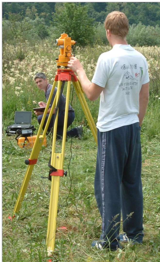
Slika. Opažanje deklinacije null metodom. Fluxgate Mag A sonda montirana je na durbin teodolita, a magnetometar Mag-01H udaljen je nekoliko metara od opažača. Zapisničar bilježi vremena i očitavanja 4 položaja u formular, te u notebook, koji služi i za računanje opažane deklinacije.
