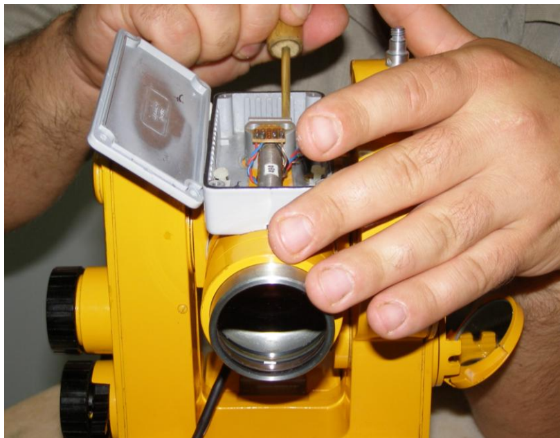
Slika. Rektifikacija neparalelnosti osi fluxgate sonde i kolimacione osi.
