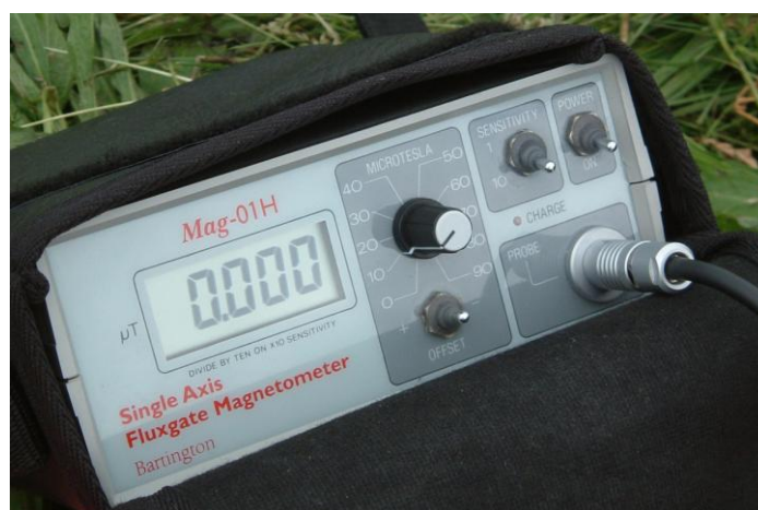
Slika. Opažanje deklinacije null metodom. Fluxgate Mag A sonda montirana je na durbin teodolita, a magnetometar Mag-01H udaljen je nekoliko metara od opažača. Zapisničar bilježi vremena i očitavanja 4 položaja u formular, te u notebook, koji služi i za računanje opažane deklinacije.
