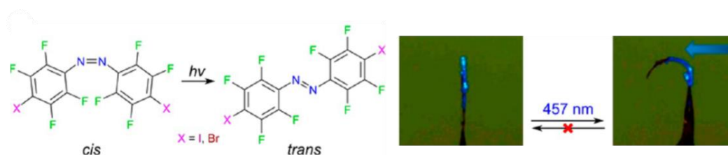
Slika 10. Shematski prikaz ireverzibilne cis → trans izomerizacije cis -4,4'-dijodoktafluorazobenzena ili cis -4,4'-dibromoktafluorazobenzena u čvrstom stanju (lijevo) te prikaz ireverzibilnog savijanja tankog kristala cis -4,4'-dibromoktafluorazobenzena prilikom izlaganja svjetlosti valne duljine 457 nm (desno)
