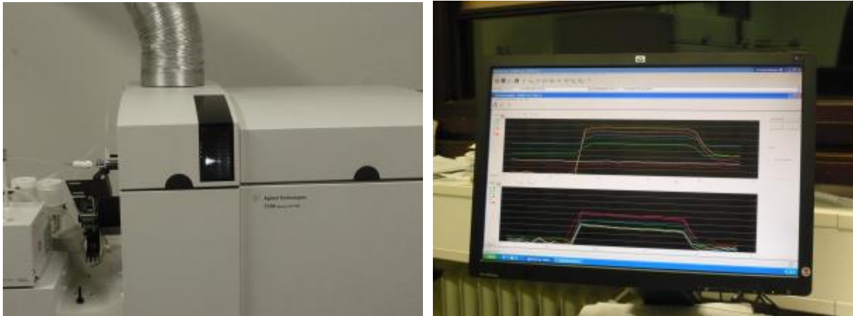
LA-ICP-MS u Stuttgartu korišten u analizi cirkona i apatita.
