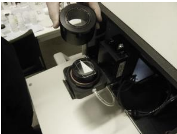
Datiranje cirkona LA-ICP-MS tehnikom (Institut für Mineralogie, Stuttgart).
