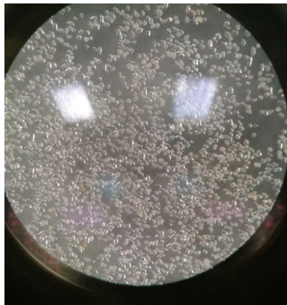
Separacija akcesornih minerala za pripremljena za izradu preparata promatrana lupom.
