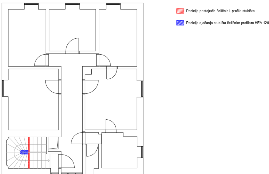
Slika 90: Pozicija izvedbe ojačanja stubišta - tlocrt 2. kata
