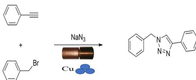
Slika 12. Shema mehanokemijske reakcije fenilacetilena s benzilbromidom i natrijevim azidom uz korištenje bakrovih kuglice i bakrove posudice. 30
