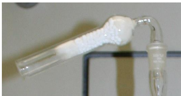
Slika 17. Klor-kalcijeva cijev spojena na hladilo
