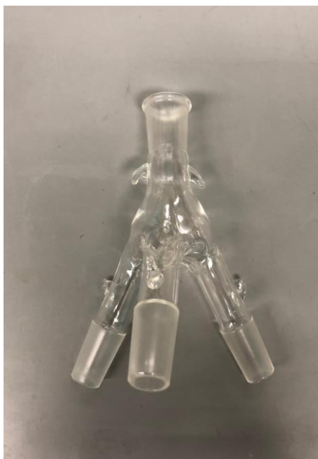
Slika 45. a) Aparatura za destilaciju pri sniženom tlaku; b) nastavak za skupljanje destilata tzv. kravica
