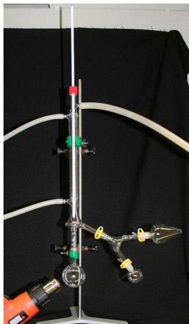
Slika 45. a) Aparatura za destilaciju pri sniženom tlaku; b) nastavak za skupljanje destilata tzv. kravica
