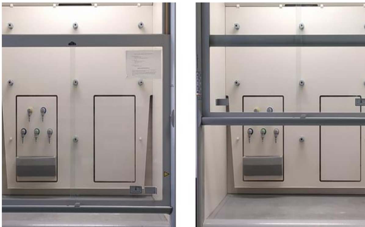
Slika 5. Digestor sa spuštenim prednjim staklom (lijevo) i s maksimalno podignutim prednjim staklom (desno)
