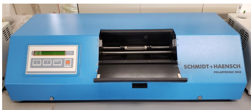
Slika 60. Polarimetar i različite izvedbe ćelija za mjerenje optičkog skretanja
